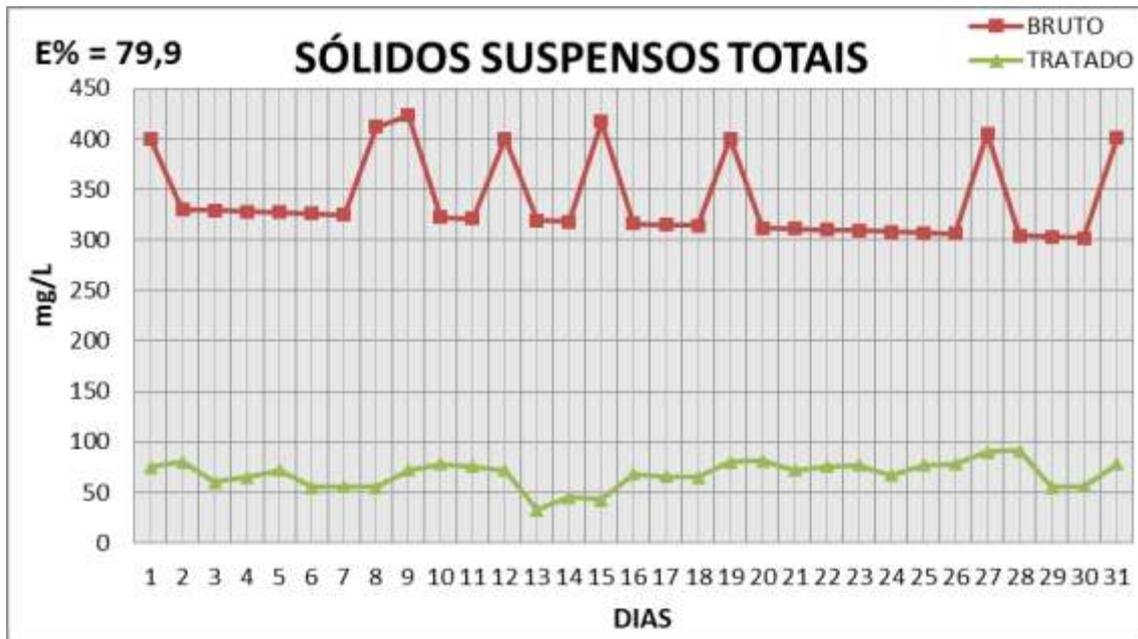
Figura 9. Curvas do comportamento da variação dos sólidos suspensos totais no efluente bruto e tratado ao longo do período avaliado de 31 dias do mês de setembro de 2011.
