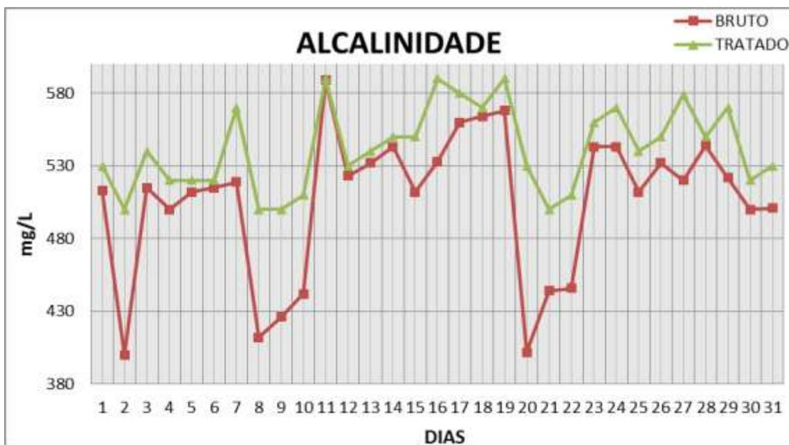
Figura 2. Curvas do comportamento da variação da alcalinidade no efluente bruto e tratado ao longo do período avaliado de 31 dias do mês de setembro de 2011.
